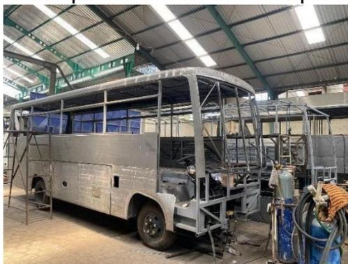
**Gambar 3.** Proses produksi karoseri
