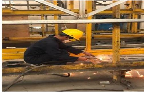
**Gambar 9.** Pengelasan *Body* Rangka
