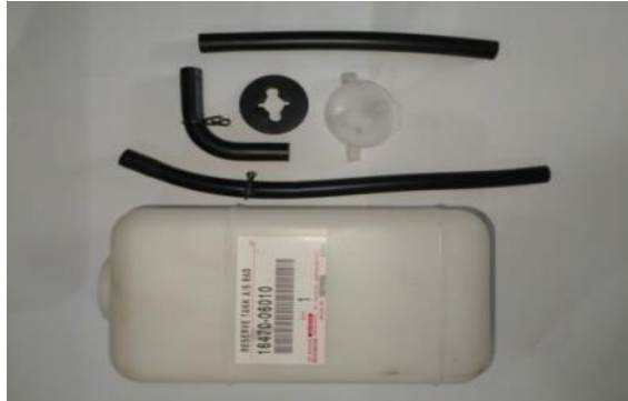
Gambar 4. Oil Catch Tank dengan Filter Busa 1 Micron
