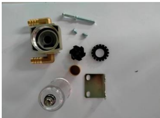
Gambar 3. Oil Catch Tank dengan Filter Busa 0.5 Micron
