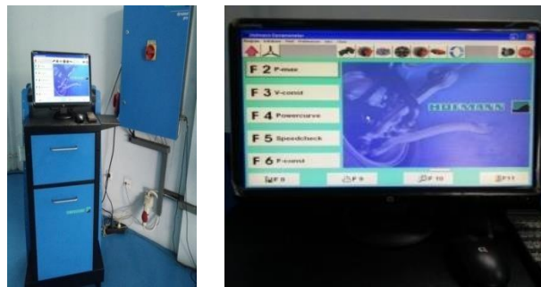
Gambar 2. Alat Uji Chassis Dynamometer
