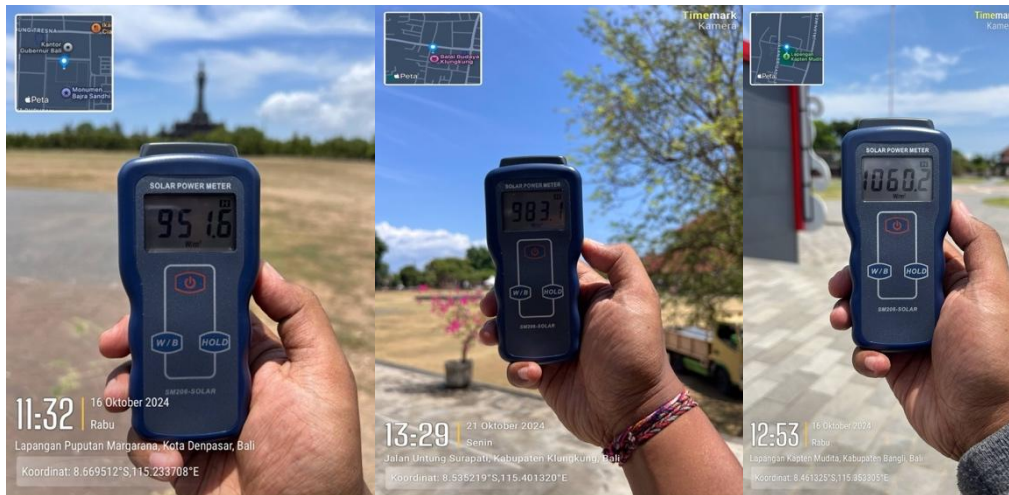
Gambar 6. Hasil pengukuran dengan Solar Power Meter
